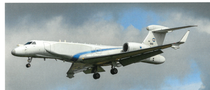
Mit ihren Antennen und Sensoren fast nicht als Gulfstream 550 erkennbar ist diese von Israel Aircraft Industries stark modifizierte «Nahshon-Eitam», welche als Frühwarn- und Kommando-posten dient.
