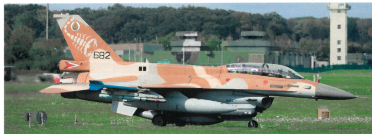
Zur israelischen Delegation gehörten drei F-16D Barak der 105. Staffel «The Scorpions» aus Hatzor, bei denen auf dem Rücksitz ein Waffensystem-Operator mitfliegt. Am Lufteinlass ist der Rafael Litening-Pod zur Zielerfassung zu erkennen, in hellblau eine Python 4/5 Trainingslenkwaffe und am Flügelende eine Sidewinder-Attrappe zur Aufzeichnung der geflogenen Parameter.
