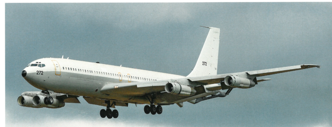
Die israelische Luftwaffe ist eine der letzten Betreiber der Boeing 707, in Israel «Re'em» – hebräisch für Oryx-Antilope – genannt. Die Veteranen werden als Tanker und Transporter eingesetzt und in naher Zukunft von KC-767 abgelöst.
