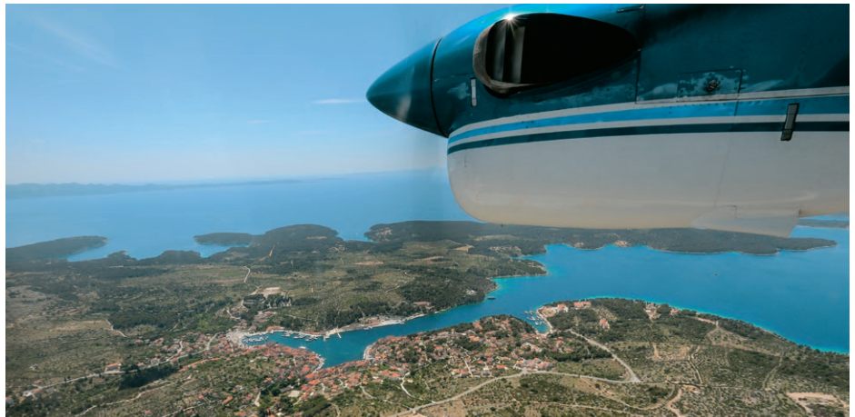
135 Knoten (250 km/h) schnell ist die Twin Otter mit Floats. Diese kosten gegenüber dem reinen Radfahrwerk 25 bis 30 Knoten an Speed.
