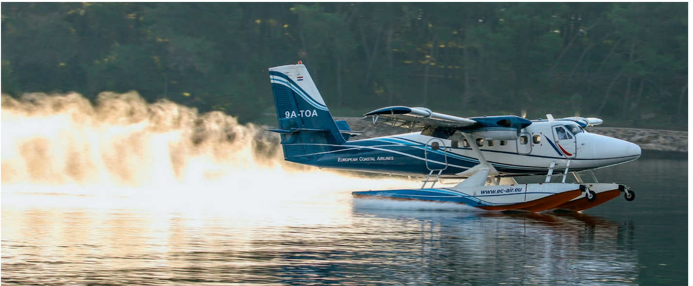
Die Twin Otter 9A-TOA ist ein Amphibienflugzeug und kann mit ausfahrbaren Rädern in den Floats auch auf Pisten landen. Die Amphibienausrüstung mit Floats wiegt bei einem maximalen Startgewicht von knapp 5670 Kilogramm allerdings beinahe eine Tonne.
